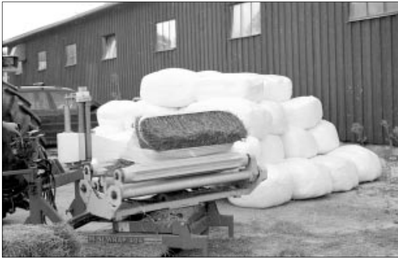
FIGUR 2. Inplastning av små fyrkantbalar. Balarna måste väga minst 30 kilo för att inplastningen ska ske problemfritt.
